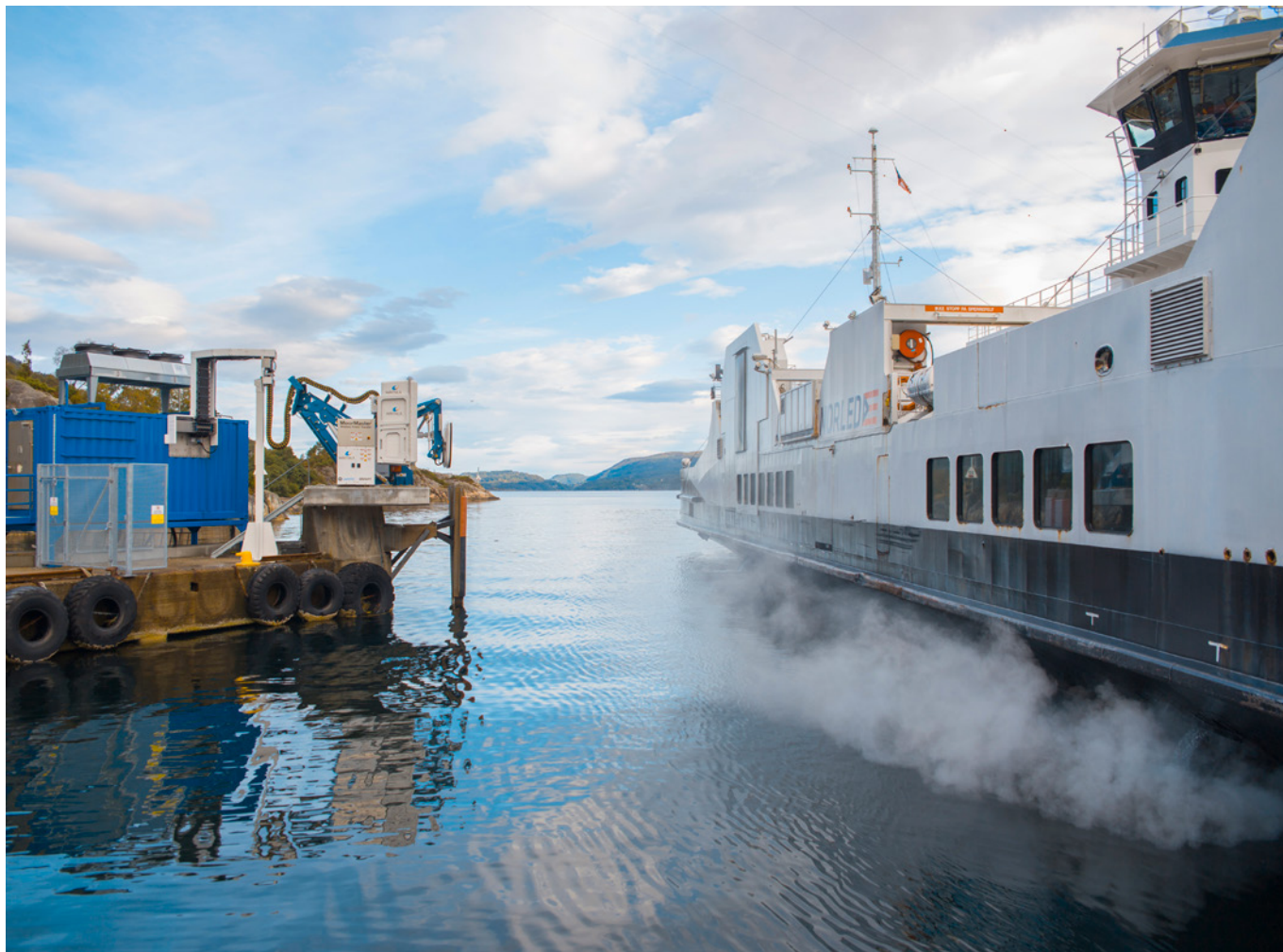
På M/F Folgefonn – som trafikkerer Jektavik–Nordhuglo–Hordanes i Hordaland – prøves ut systemet med trådløs lading. Foto: Wärtsilä
